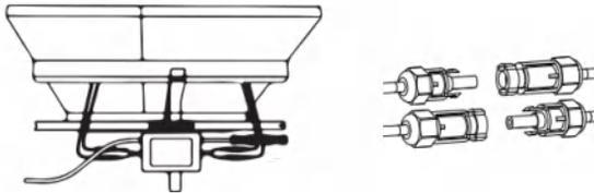
**HINWEIS:** Wenn beim Einstecken der DC-Kabel bereits Wechselstrom vorhanden ist, sollte der Mikrowechselrichter sofort rot blinken und innerhalb der eingestellten Zeit (Standard 60 Sekunden) mit der Arbeit beginnen. Wenn kein Wechselstrom vorhanden ist, blinkt das rote Licht dreimal schnell und wiederholt sich nach einer Sekunde, bis der Wechselstrom angeschlossen ist.
